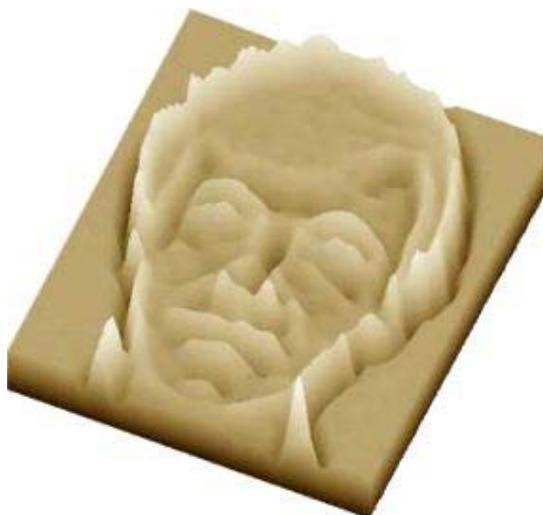
Рис. 7. Пример изображения, сформированного методом наночеканки
